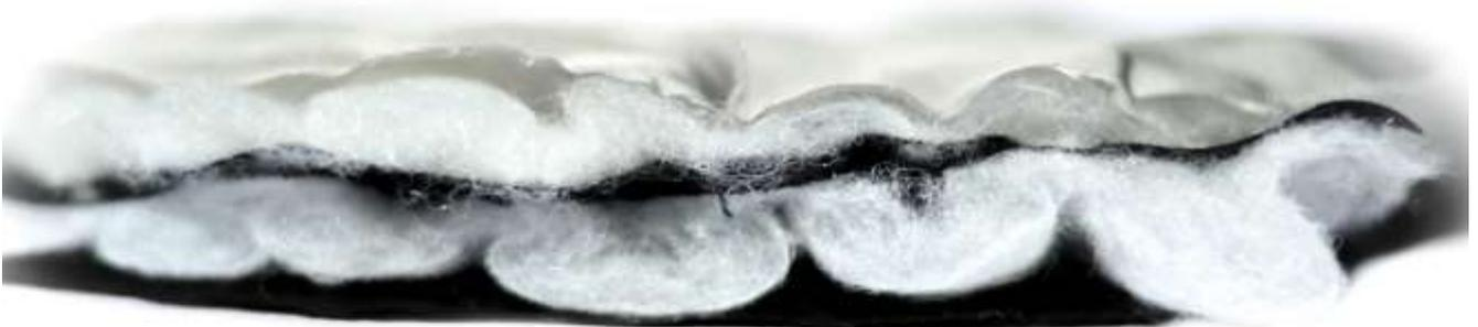
Рисунок 3.5 – Снимок поперечного среза пакета №2 (с проектируемым комплексом № 2)
