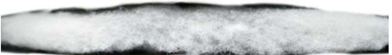
Рисунок 3.4 – Снимок поперечного среза пакета №1 (с холлофайбером 150 г/ м<sup>2</sup>)
