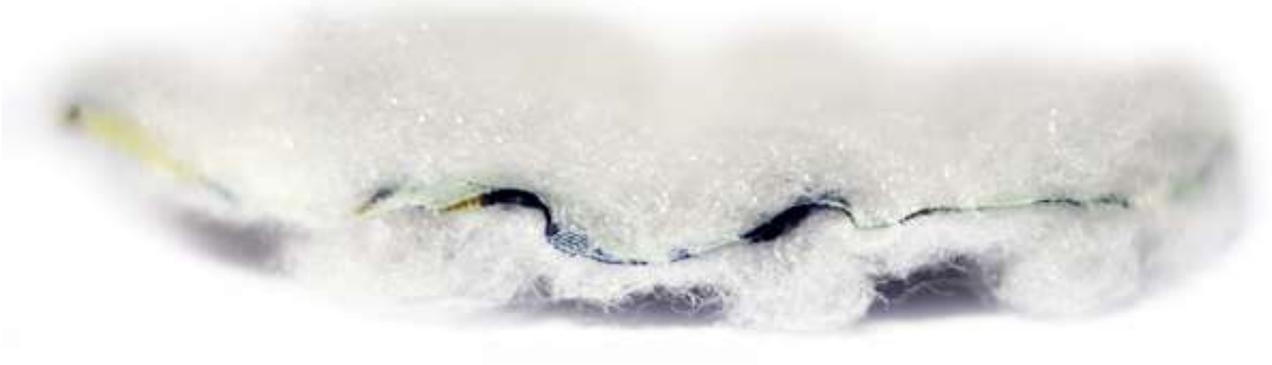
Рисунок 3.3 – Снимок поперечного среза проектируемого утеплителя №2 (холлофайбер 50 г/ м<sup>2</sup>+ сетка «Бифлекс» + холлофайбер 50 г/ м<sup>2</sup>)
