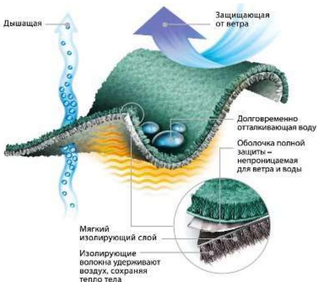
Рисунок 1.10 – Структура материала Windbloc
