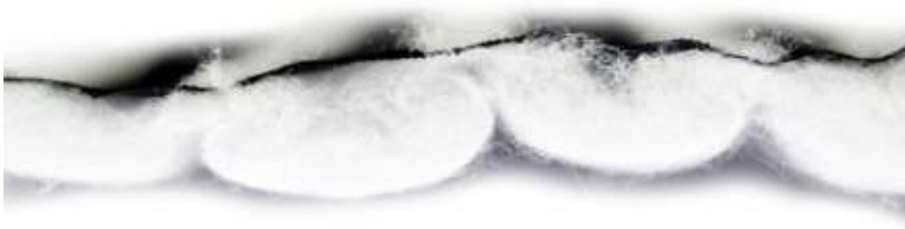
Рисунок 3.2 – Снимок поперечного среза проектируемого утеплителя №1
