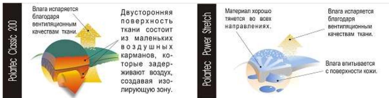
Рисунок 1.1 – Структура трикотажного полотна Polartec
