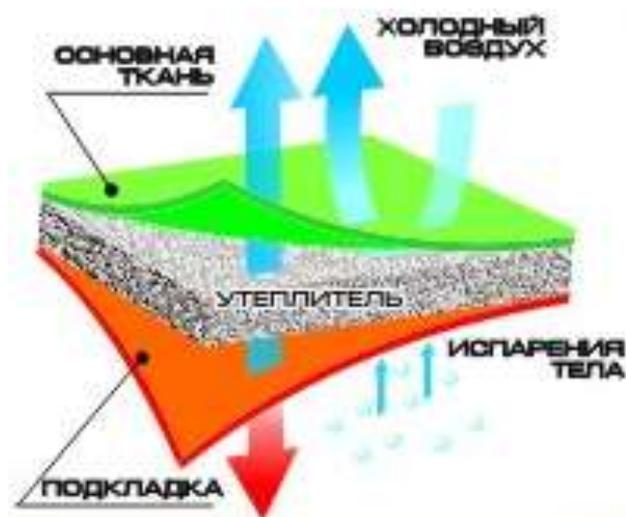
Рисунок 1.14 – Конструкция материала HoloFiber
