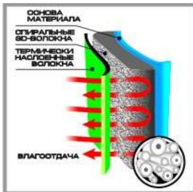
Рисунок 1.13 – Структура материала Thermolite
